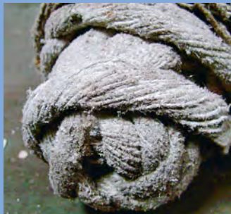
Cordons en amiante
