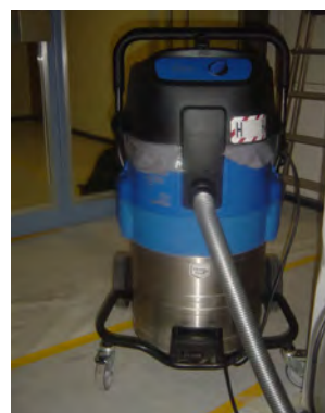
3 Aspirateur industriel de classe H (amiante).
